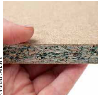
Bild 10: Swiss Krono entwickelte eine Spanplatte mit biobasiertem Klebstoff
