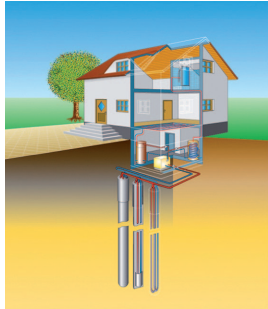
Umweltwärmenutzung mittels Wärmepumpe und Erdwärmesonde (Quelle: www.iwr.de)
